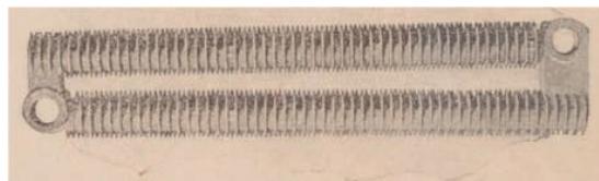
Figura 7. Model Excelsior de tubs d'aletes (Debesson, 1920: 362).
